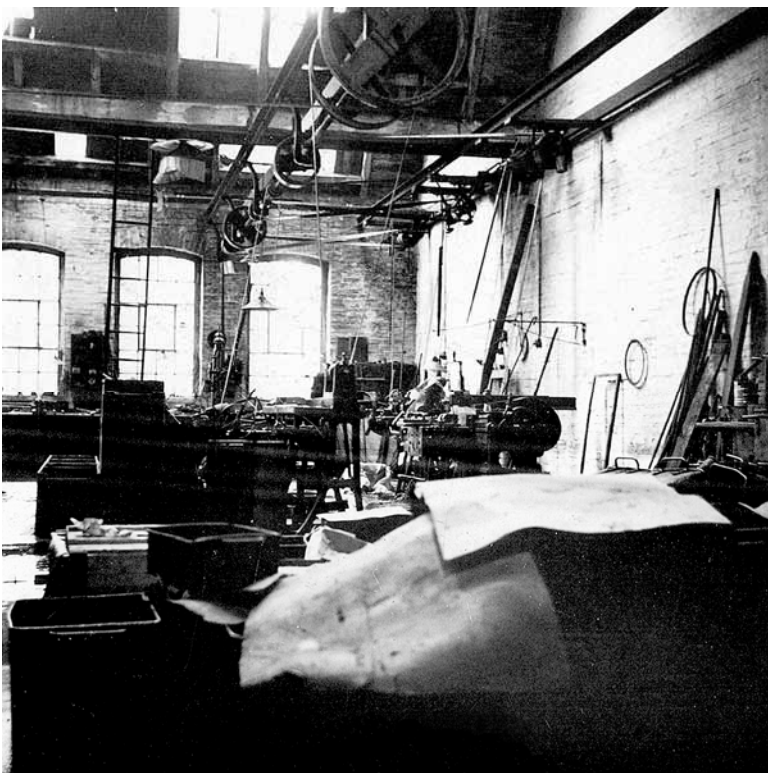
Produktion in den 1940er Jahren (teilweise noch Antrieb mit Transmissionsriemen)
